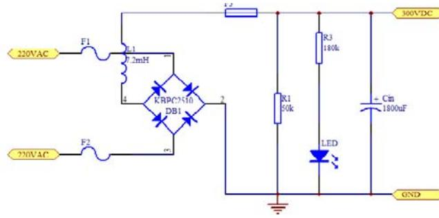
Fig.2: Rectifier Filter Circuits
