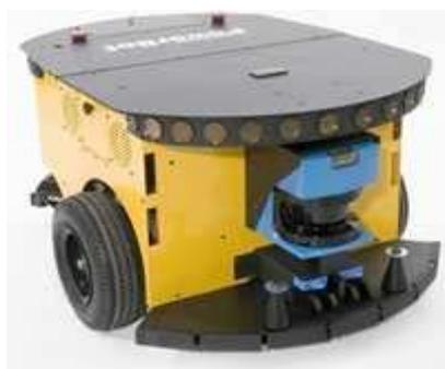
Figure 1. Powerbot robot.
